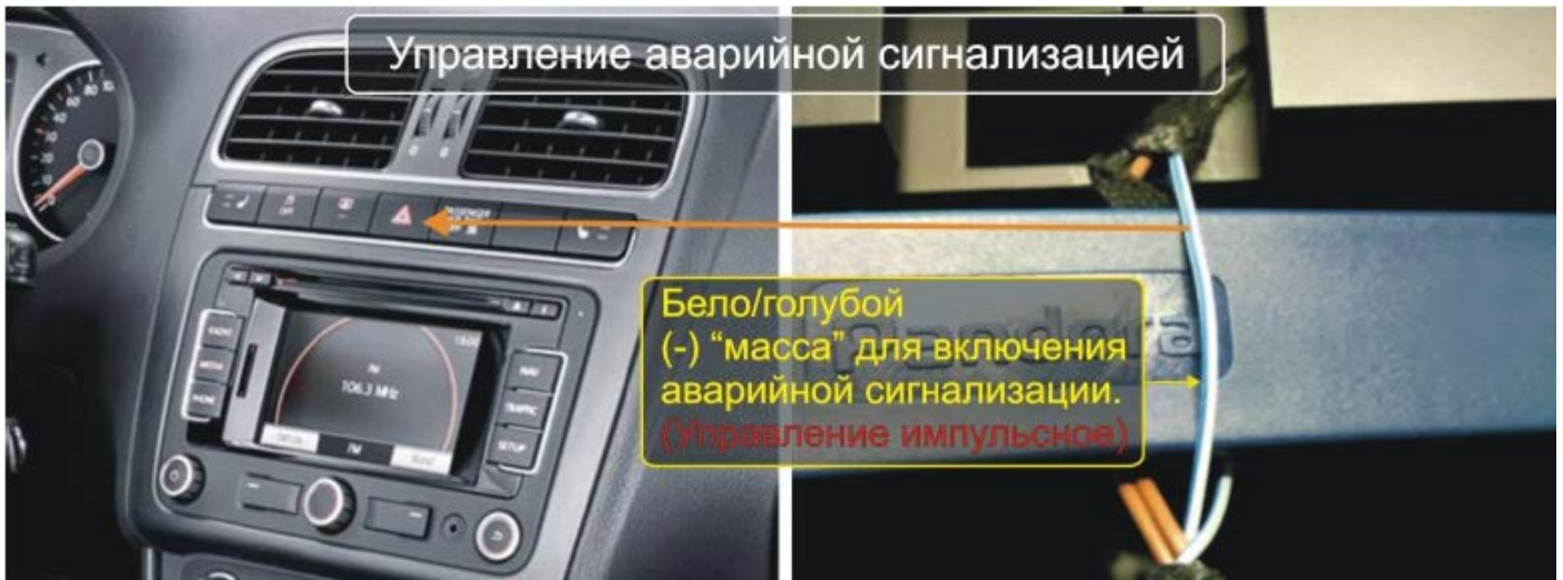
Кнопка аварийной сигнализации в салоне
